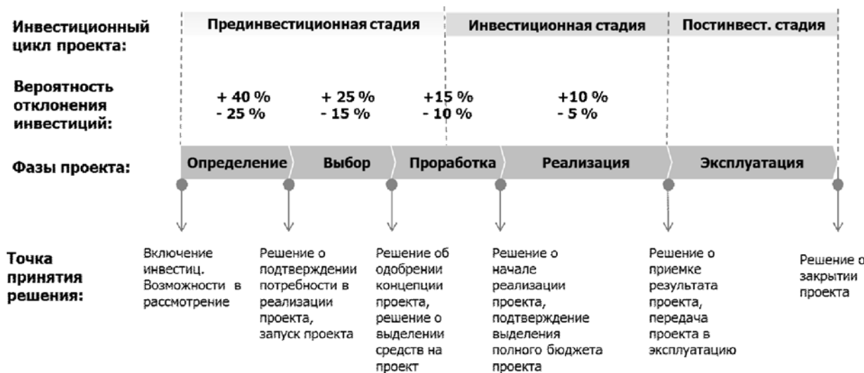
Рис.2 – Динамика прогноза проектных инвестиций в контексте фазовой модели управления проектом (составлено автором с использованием данных компании Arcadis и McKinsey [7,8]).
