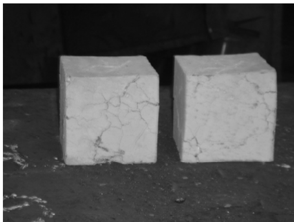
Рис. 3. Разрушение неводонасыщенных образцов
